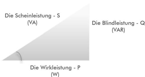
Um die Echtzeitberechnung der Blindleistung mit der G3 Echtzeitmathematik-Option des DL850 ausführen zu können, müssen die verbleibenden Anteile des Leistungs-dreiecks (Scheinleistung und Wirkleistung) zuvor mit der Echtzeitmathematik berechnet werden.
