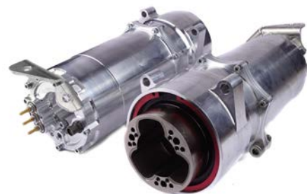
Als Antrieb des auf dem Titelbild gezeigten Fahrzeugs KIT17E dient ein selbstentwickelter, permanenterregter Synchronmotor mit eigenem Ölkühlkreislauf.
