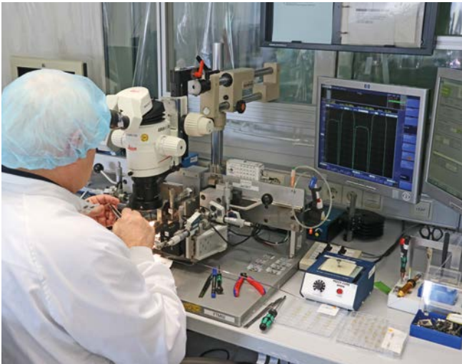
Die Justierung der optischen Komponenten erfolgt unter dem Mikroskop.
